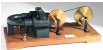
Диск Фарадея - первый электромагнитный генератор. При вращении диска вырабатывается постоянное напряжение.
