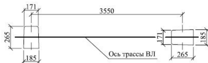
Схема установки стойки СВ95-3 (СВ95-3с)
