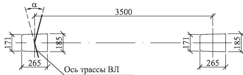
Схема установки стойки СВ95-3
